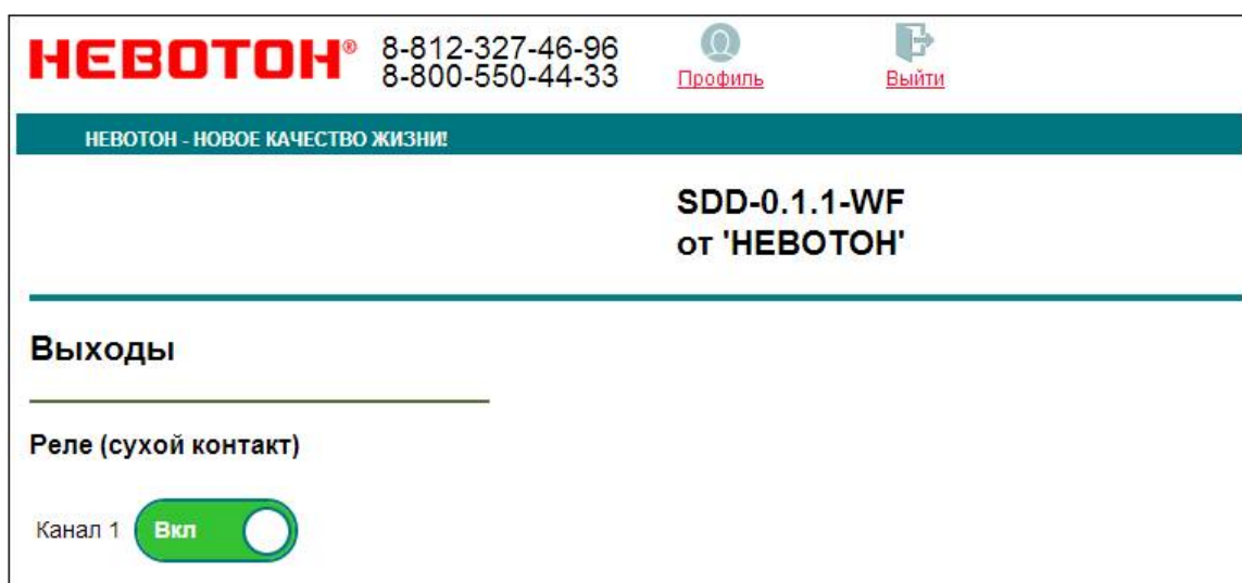
Рисунок 10. Изменение состояния выходного канала в web-интерфейсе Устройства
