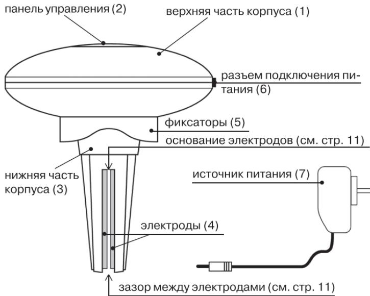
Рисунок 1 – Ионизатор «НЕВОТОН». Общий вид
