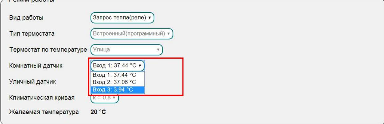
Рисунок 23 – Выбор датчика температуры
