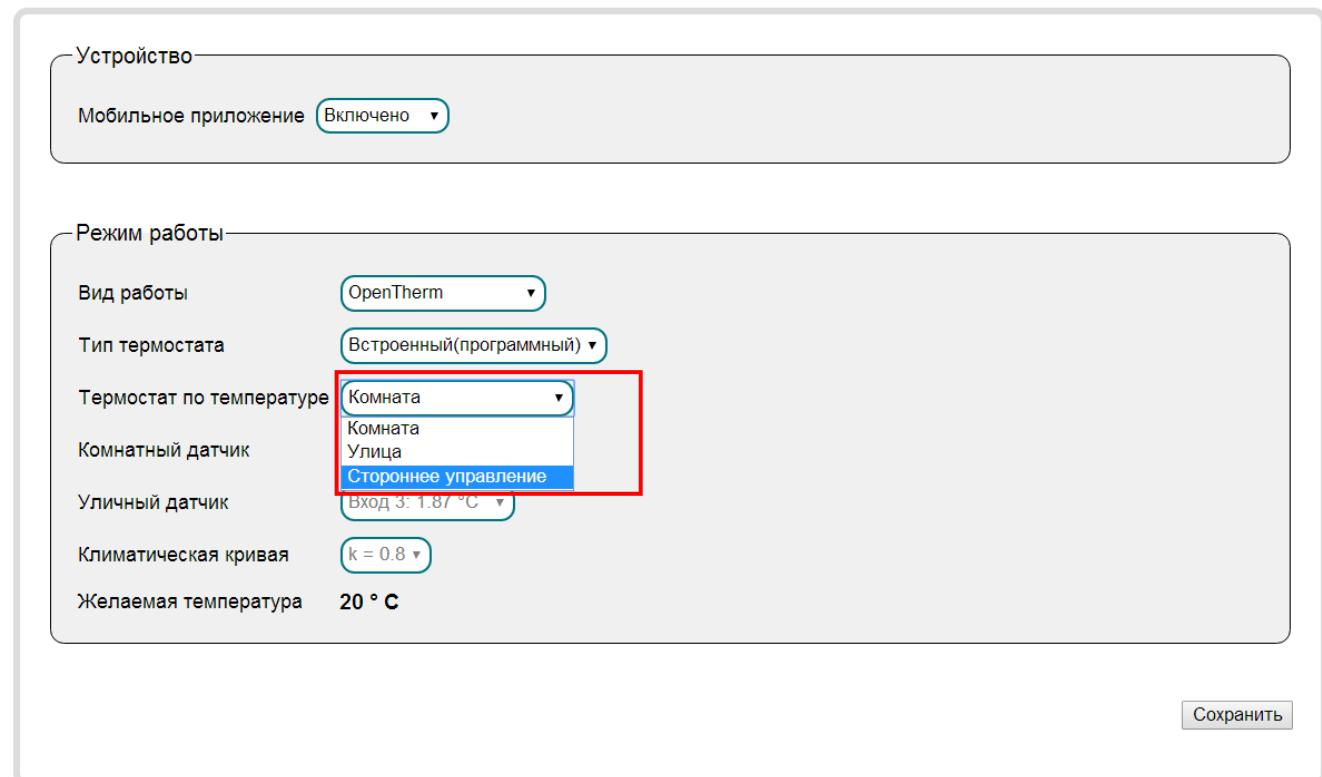
Рисунок 19 – Выбор управляющего алгоритма «Терmostат по температуре»
