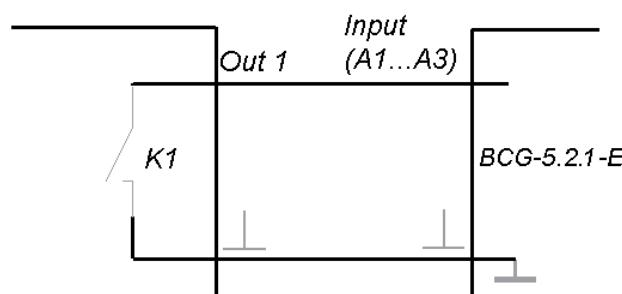
Рисунок 4 – Подключение оборудования с выходом типа «сухой контакт»
