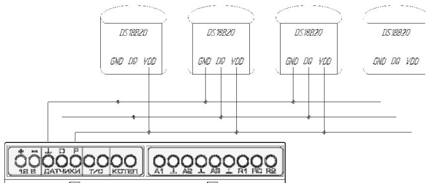
Рисунок 3 – Подключение датчиков DS18B20 по шине 1-wire
