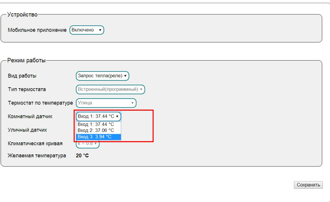
Рисунок 24 – Выбор датчика температуры
