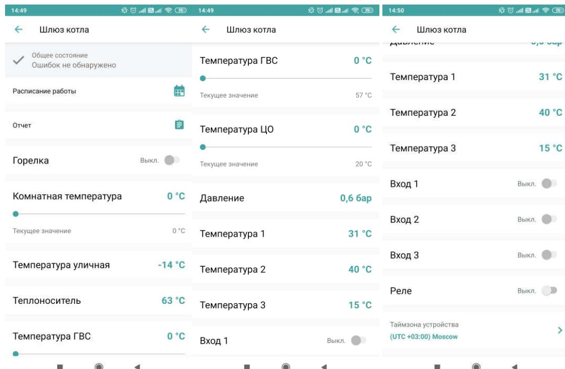
Рисунок 31 – Интерфейс Устройства в мобильном приложении
